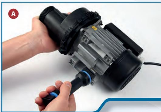
An der Unterseite der Pumpe befindet sich ein C-Profil, das zur Pumpenbefestigung benötigt wird.
