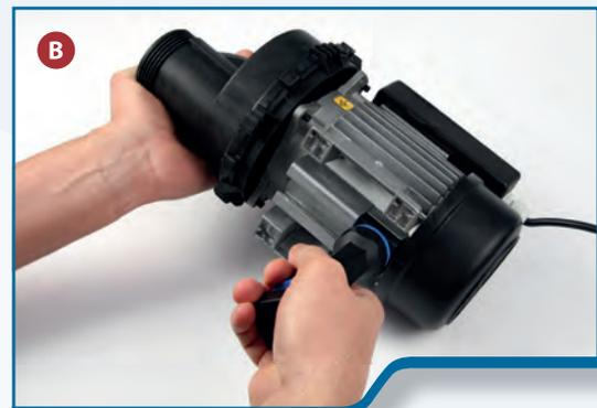
Quadratischen Nutstein (Beschriftung „LEFT“) des Quick Fix Vario in das C-Profil der Pumpe einschieben.
