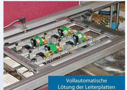
Vollautomatische Lötung der Leiterplatten
