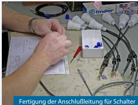
Fertigung der Anschlußleitung für Schalter
