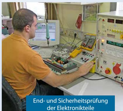
End- und Sicherheitsprüfung der Elektronikteile
