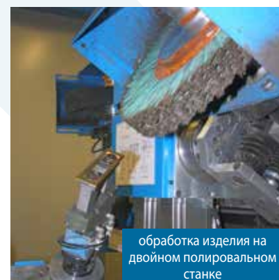
4 держателя заготовки, каждый с 2 валами, 1 шлифовальный узел с 2 шлифовальными станками, 2 двойных полировальных блока, каждый с 2 полировальными станками - все станки с 5 валами
